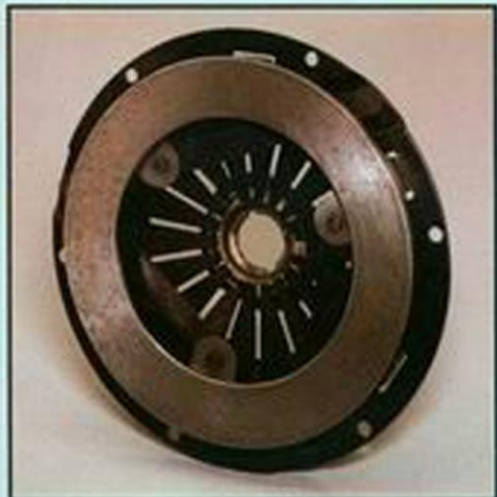
Kupplung T 160 mit Bandmitnahme und Kupplungsscheibe 160 DBR mit Drehschwingungsdämpfer – Dadurch weiches Einkuppeln beim Anfahren und Gangwechsel – Verringerung des Verschleißes des Nabenprofils –
