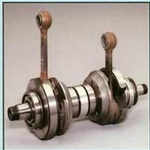
Kurbelwelle mit Kolbenringabdichtung und Standardlagern – Massereduzierter Kolben,
