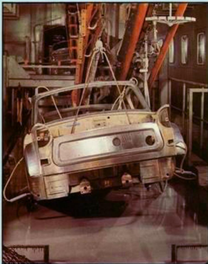
Elektrophoretische Grundierung des Stahlgerippes
