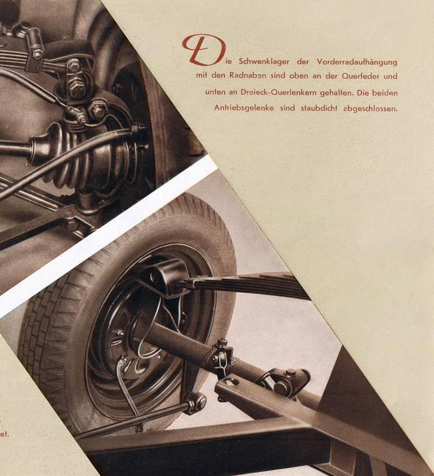
Die Hinterachse ist als Starrachse ausgebildet, die an der hochgelegten Querfeder aufgehängt ist, daß die bekannte „Schwebeachse“ entsteht, die dem Fahrzeug in Verbindung mit der achslosen Aufhängung der Vorderräder, der abgestimmten Stoßdämpfung und den sonstigen Fahrgestell-Dimensionen seine unübertroffene Straßenlage stets gewährleistet.
