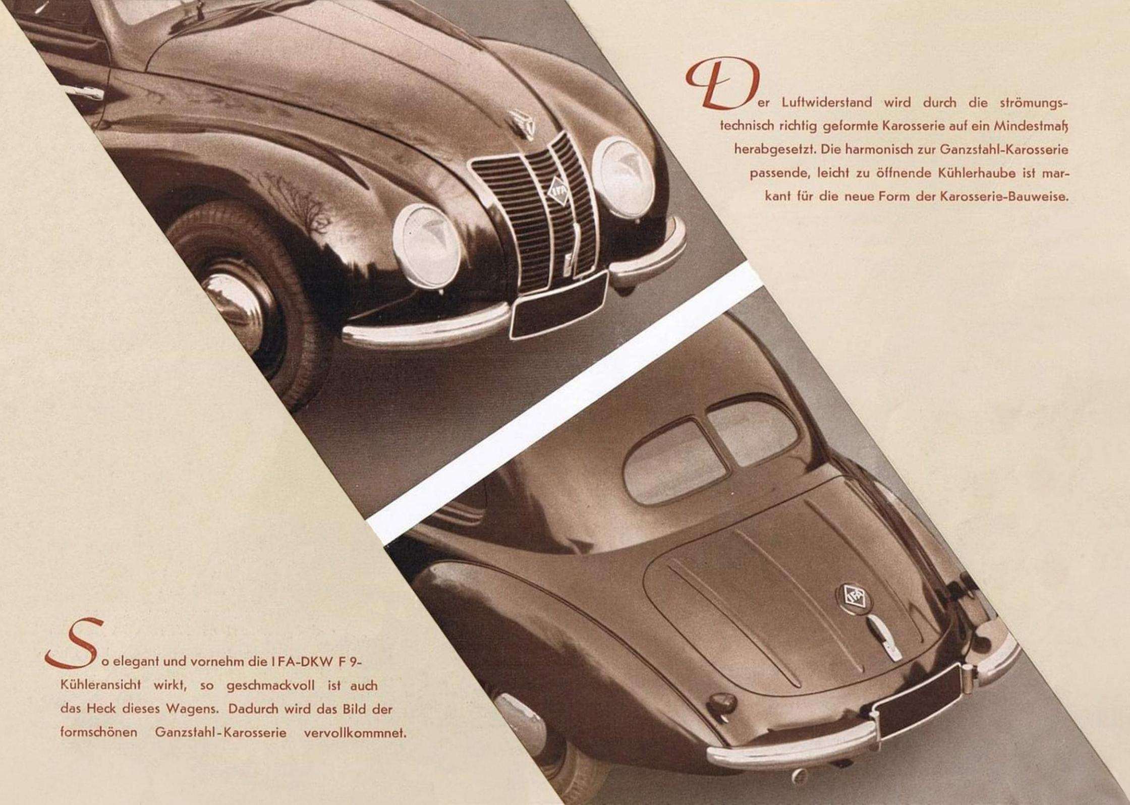
Der Luftwiderstand wird durch die strömungstechnisch richtig geformte Karosserie auf ein Mindestmaß herabgesetzt. Die harmonisch zur Ganzstahl-Karosserie passende, leicht zu öffnende Kühlerhaube ist markant für die neue Form der Karosserie-Bauweise.
