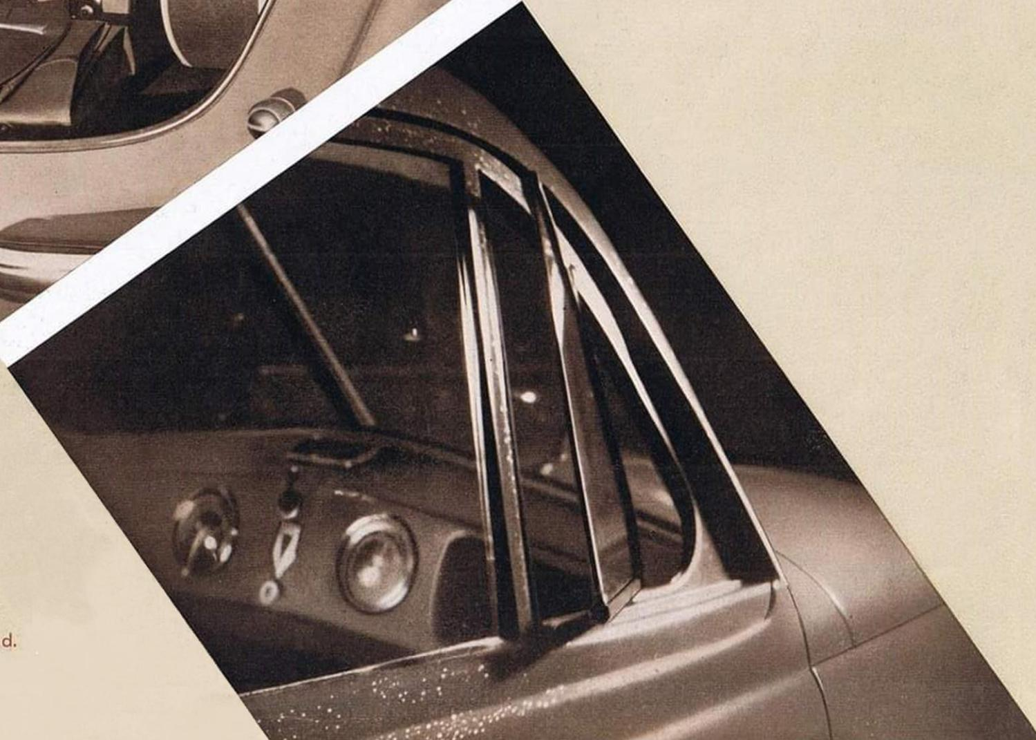
Die großen, gut im Blickfeld liegenden, leicht zu öffnenden Seitenfenster ermöglichen den Insassen gute Sicht. Das im Bild gezeigte Ausstellfenster sorgt für Frischluftzufuhr auch bei Regenwetter, ohne daß die Fahrgäste den Einflüssen der Witterung ausgesetzt sind.
