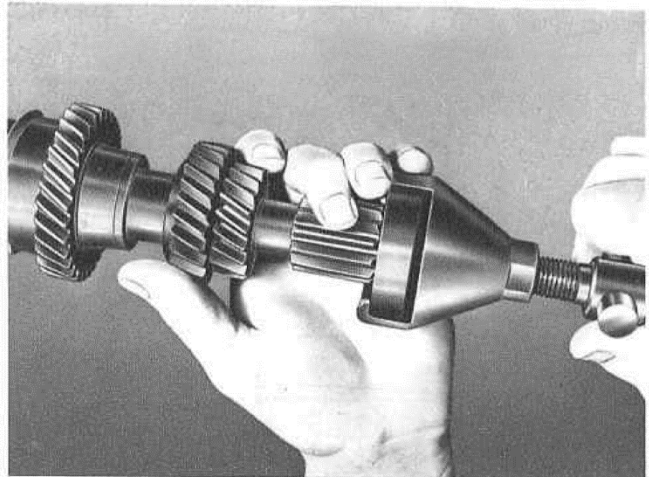
Bild G 13. Rillenkugellager, hinten, abziehen
