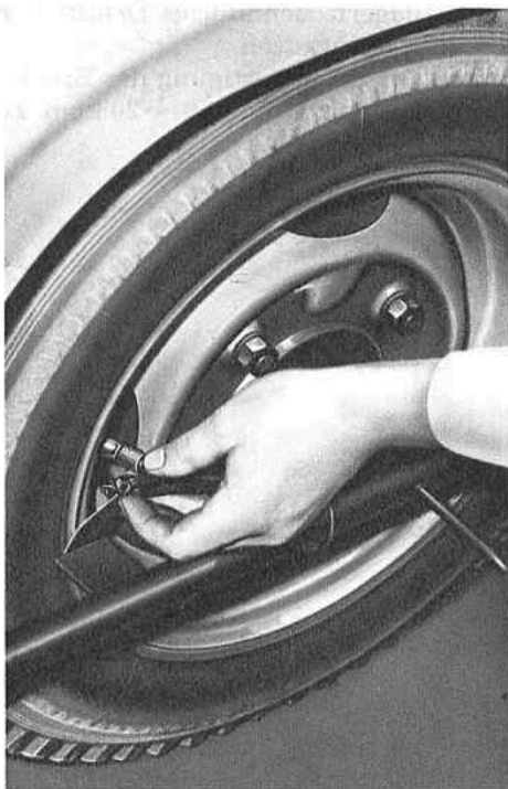
Bild F 27. Hinterräder – Vorspur überprüfen
