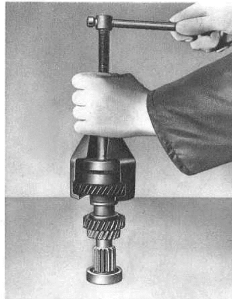
Bild G 12. Rillenkugellager und 4. Gangrad abziehen
