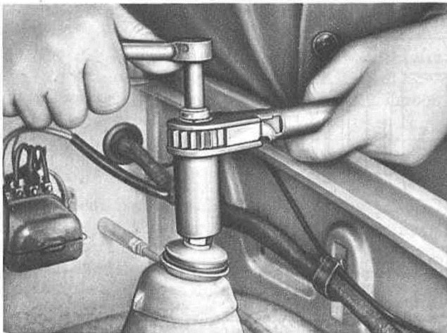
Bild F 38. Stoßdämpferbefestigung lösen
