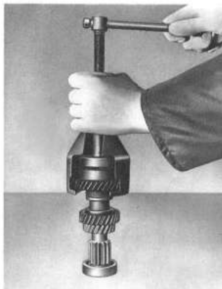
Bild G 12. Rillenkugellager und 4. Gangrad abziehen
