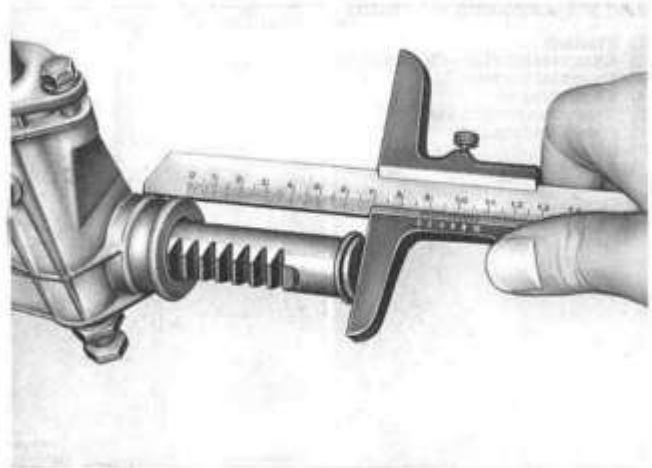
Bild F 7. Zahnstange in Mittelstellung
