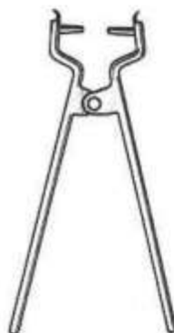
Zange zum Aus- und Einhängen der Bremsbacken
