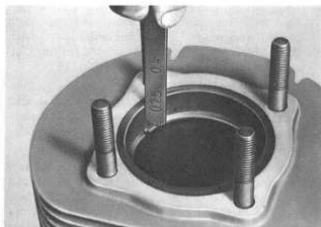
Bild M 37. Kolbenringstoßmaß ermitteln
