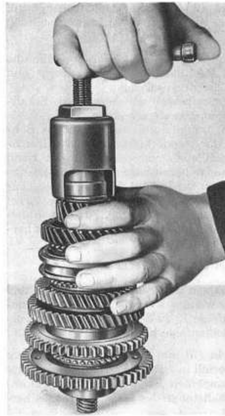
Bild G 16. Innenring vom Zylinderrollenlager abziehen
