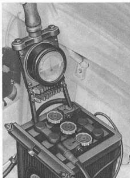
Bild E 13. Batteriespannung überprüfen
