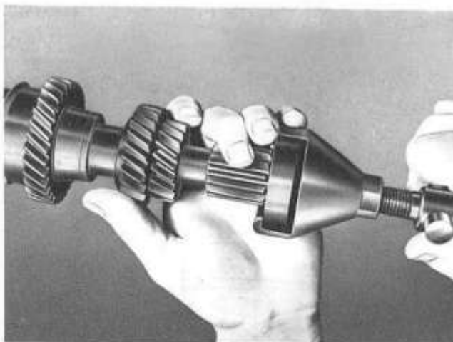
Bild G 13. Rillenkugellager, hinten, abziehen
