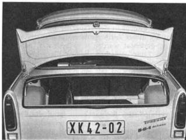
Bild K 2. Heckklappenabdichtung
