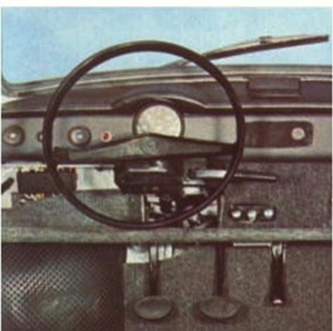
Der IFA-Trabant 601 S mit Zündanlaßlenk-schloß, Intervallschalter für Scheibenwischer, Instrumententafel mit Schaumwulst und zusätzlicher Ablage sowie Warnblinkanlage erweitert die Grundausstattung.
