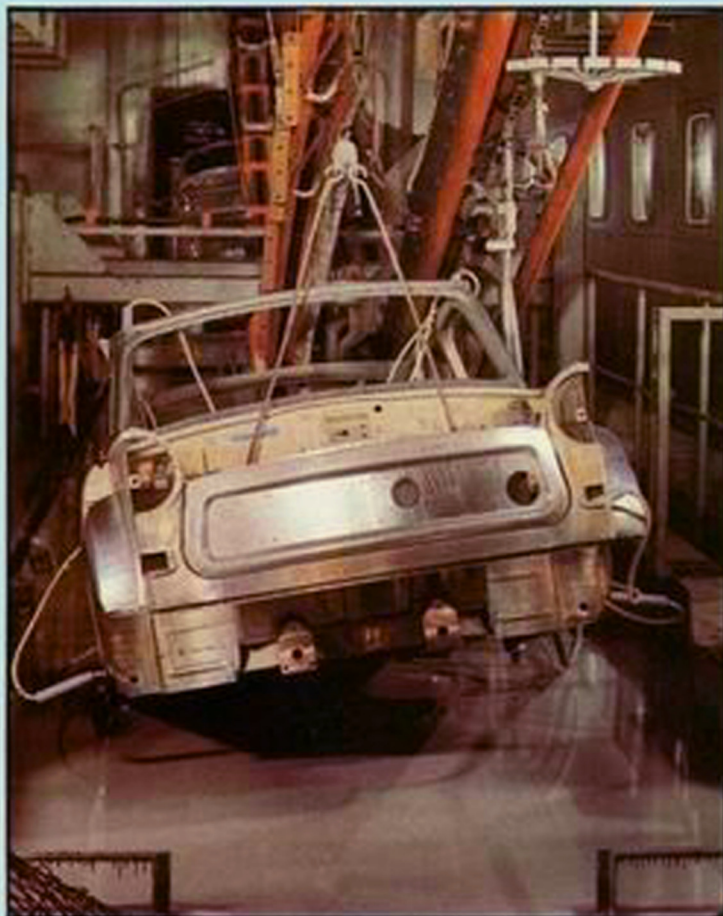
Elektrophoretische Grundierung des Stahlerippes
