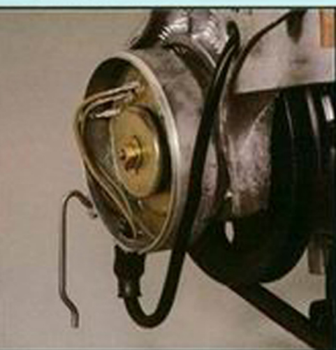
Kupplung T 160 mit Bandmitnahme und Kupplungsscheibe 160 DBR mit Drehschwingungsdämpfer – Dadurch weiches Einkuppeln beim Anfahren und Gangwechsel – Verringerung des Verschleißes des Nabenprofils –
