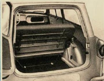
Wie bei den Vordersitzen wird auch bei der Frontsitzbank der unten befindliche Bügel in die Rosten eingelegt und die Sitzbank dadurch angehoben. Die Rückenlehne ist aus der Halterung für die Sitzstellung auszurasten und bis zu den Anschlagwinkeln an der Hinterradverkleidung umzuklappen.
